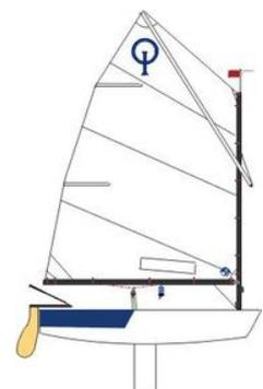
L'**Optimist** è un monoscafo dotato di una singola vela. Il disegno dell'imbarcazione è molto semplice: l'Optimist è essenzialmente una scatola in vetroresina con una mastra rinforzata per il sostegno dell'albero chiamata "panchetta".
