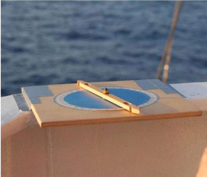
Fig. 7. Angle board – strumento di misura dell'angolo tra rotta nave e direzione dell'avvistamento
