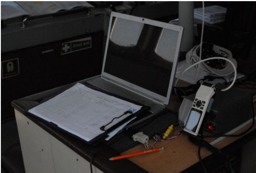
Fig. 6. Il computer con interfacciato il GPS per la raccolta automatica dei dati di navigazione su software Logger (IFAW ®)
